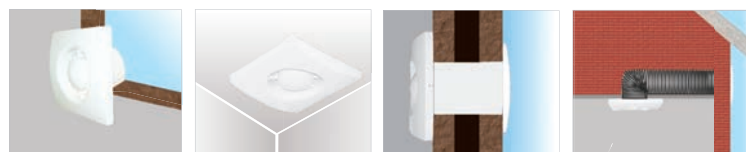
oldalfali mennyezeti közvetlen kivezetés kivezetés rövid légcsonatnál át
